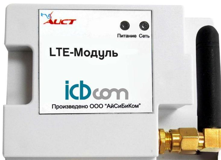
Рисунок 1 - 4G-модуль, встраиваемый в однофазный счетчик «АИСТ А100»
